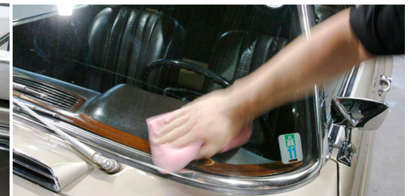
Vierter Schritt: Scheiben säubern. Reiniger mit wenig Alkohol verwenden, direkt aufs Tuch sprühen und streifenfrei putzen.
