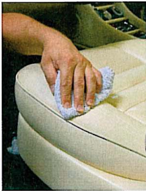
Sprühen, bürsten, wischen: Der Lederreiniger wird aufgesprüht, direkt oder auf die Bürste. Dann sofort das Leder damit kreisend und ohne Druck einreiben. Nachwischen.
