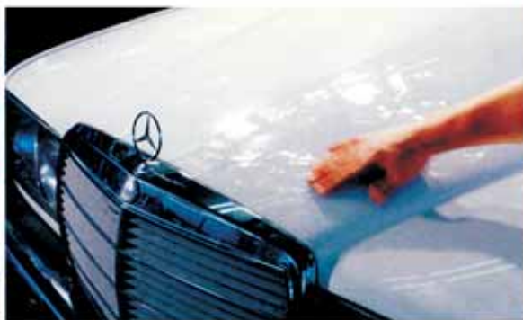
Den Feinschliff übernimmt danach Swizöl Cleaner Fluid Medium. Es gleicht die Mikrostruktur des Lacks weiter aus. Cleaner Fluid enthält keine Schleifmittel mehr, sondern schwere, polierende Öle. Saphir-Wachs versiegelt den Glanz
