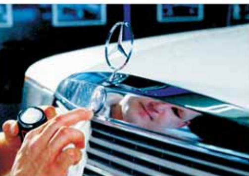
Roberto spiegelt sich nach der Anwendung von Swizöl Metal Polish in der Kühlermaske des W 123. Winzige Schleifkörper vermeiden ein Abtragen der dünnen Chromschicht
